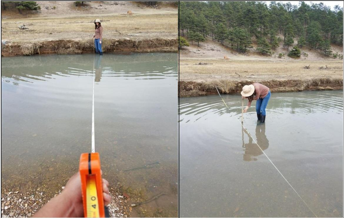
Figura 89. Medición del ancho del cauce y profundidad.
